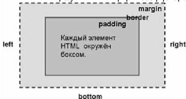
Рис. 13.1. Иллюстрация различных частей бокса элемента, помеченных соответствующими свойствами CSS
